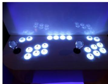
En plus des 2 fils utilisés pour le contact du bouton poussoir, les boutons lumineux ont 2 autres fils pour la led.
