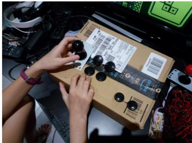
Les joysticks et boutons sont reconnus immédiatement par le système et extrêmement simples à programmer et à brancher si vous utilisez une interface USB.
