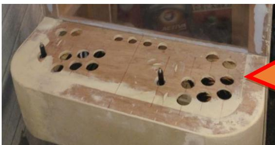
Réservation suffisante pour pouvoir placer le joystick et les boutons sans être embêté par les liteaux d'assemblage
